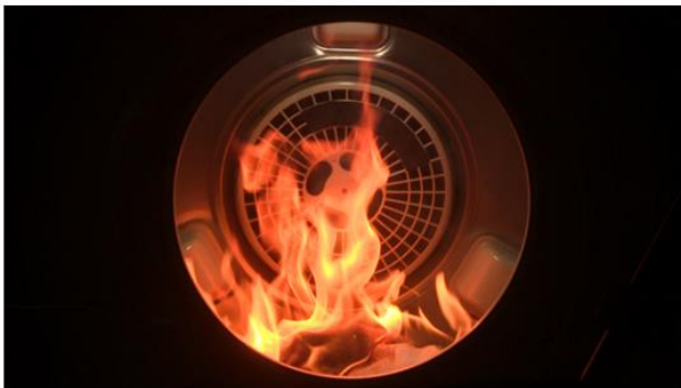
アロマオイルが付着したタオルが ドラム式洗濯機内で発火する様子（再現試験）
