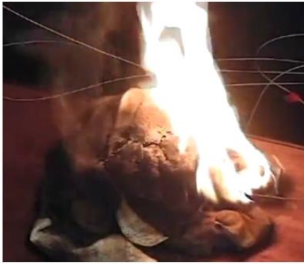
塗料を拭き取ったタオルが発火する様子（再現試験）
