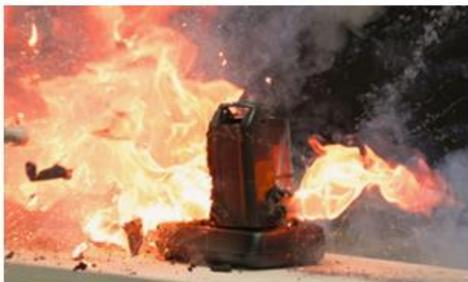
電動アシスト自転車用バッテリーが発火する様子（再現イメージ画像）
