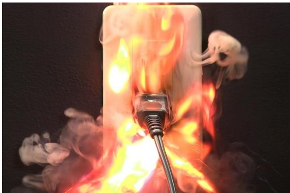
電源プラグ内部の破損による発火
