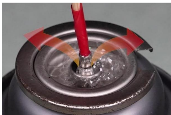
経年劣化したカセットボンベからガスが漏れている様子 （塗布した検知液がガス漏れにより発泡）
