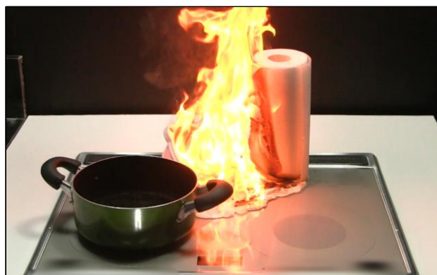
ラジエントヒーターの上に置かれた 可燃物が発火（再現実験）
