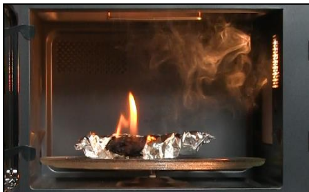
アルミホイルに包んださつまいもを レンジ加熱して発火（再現実験）
