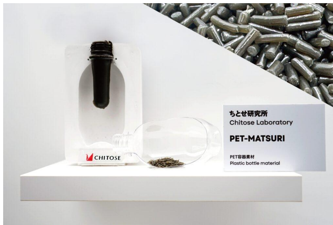
ペットボトル成形前段のプリフォームと藻類由来PET樹脂ペレット
