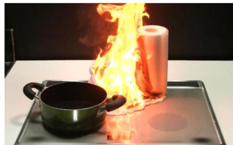
ラジエントヒーター上の可燃物が発火 (再現実験)
