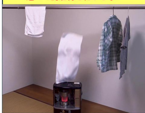
石油ストーブの上に洗濯物が落下
