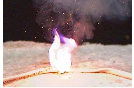
断線した電源コードの発火
