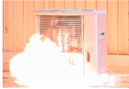
ガソリンの誤給油により爆発的に燃え上がる様子
