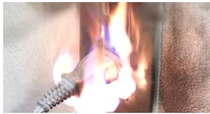
外力で変形・破損した電源プラグの発火
