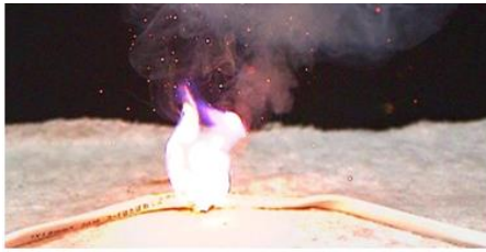
断線した電源コードの発火
