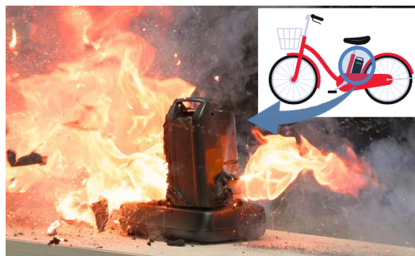
非純正バッテリー（電動アシスト自転車用） から発火する様子
