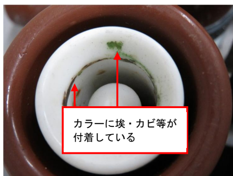
（図 3）固定モールドの汚損例
