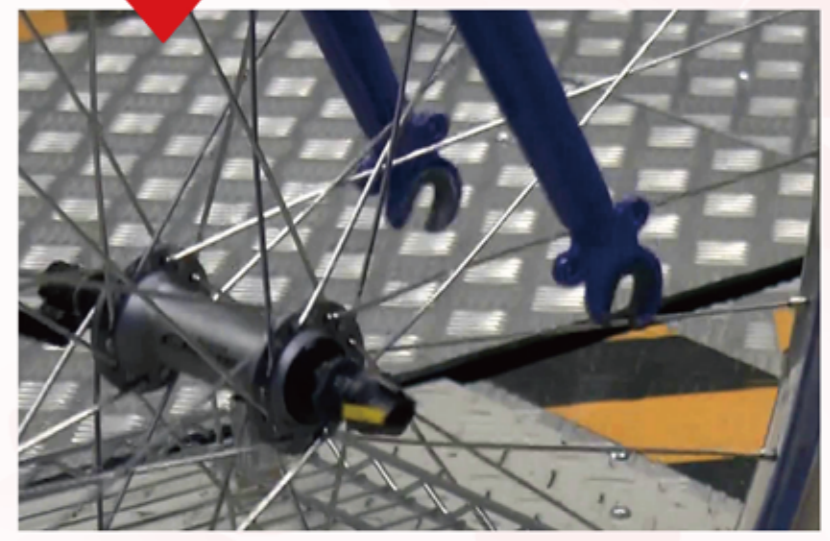
クイックリリース方式の車輪を、調整ナットの締め付けのみで固定し走行中に車輪が外れる様子
