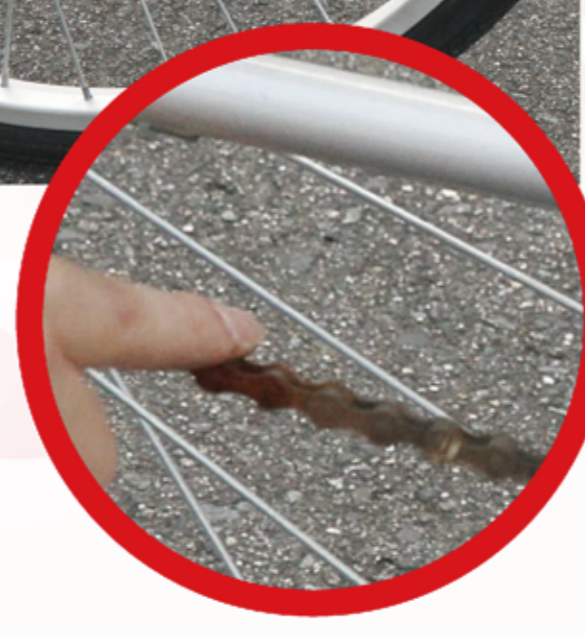
チェーンが伸びた場合やさびがひどい場合は、自転車の販売店などに相談
