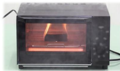
食材を加熱し過ぎて発火 (再現試験)
