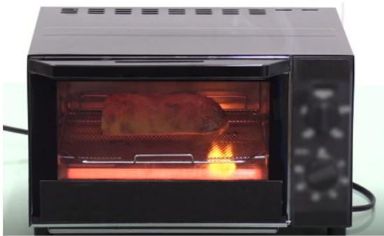
食品から滴下した油分が下ヒーター管に垂れて発火（再現試験）
