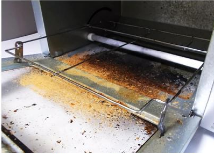
くず受け皿の上に溜まったパン屑が 焼けている様子（イメージ）
