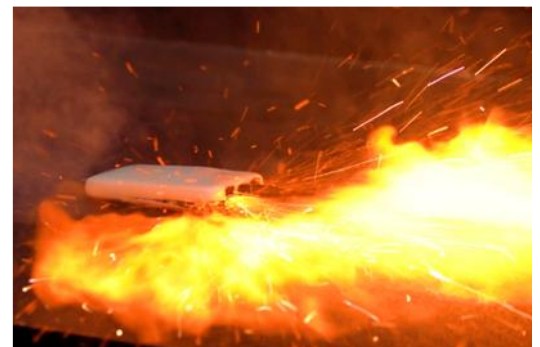
モバイルバッテリーの発火（再現実験）
