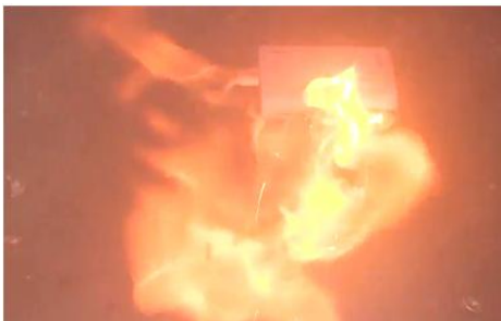
リコール品のモバイルバッテリーが 発火する様子 (再現実験)
