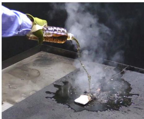
大量の水で消火している様子 （再現実験）
