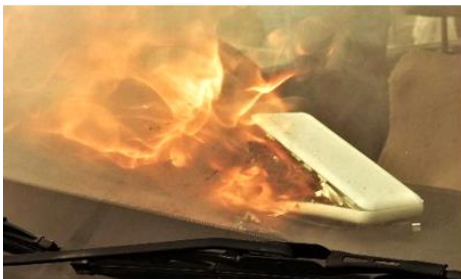
自動車内でモバイルバッテリー が発火する様子（再現実験）
