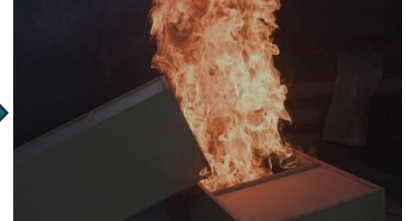
電源コードからの発火による火災
