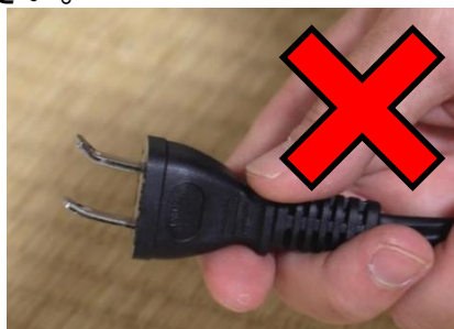
変形した電源プラグは使用しない
