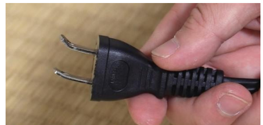
変形した電源プラグ
