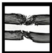
電源コード被覆内の芯線が半断線している様子 (X線写真)
