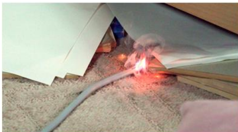
地震で転倒した家具が電源コードを破損させて発火（再現試験）
