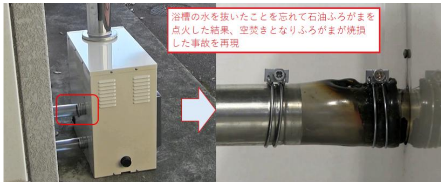
石油ふろがまの空焚きで焼損 (再現試験)
