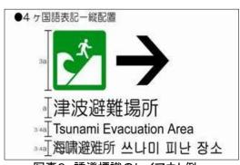
写真3 誘導標識のレイアウト例
