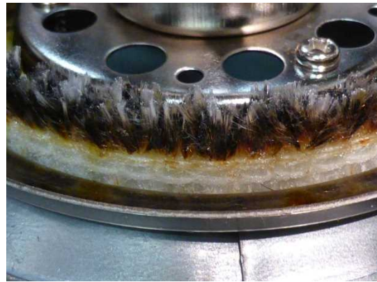
図6 変質灯油 100時間後 (拡大)
