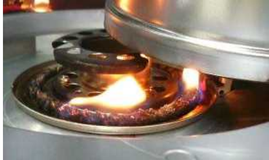
図1 芯が下がらず消火不良となった芯式石油ストーブ
