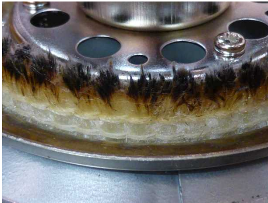
図5 正常灯油 100時間後 (拡大)
