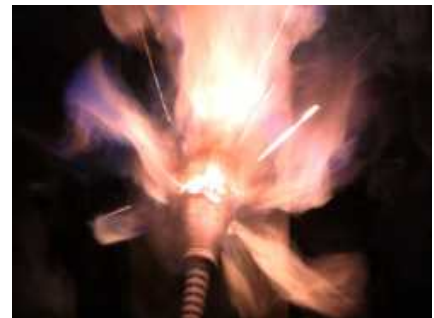
（写真）電源プラグのトラッキング現象の様子
