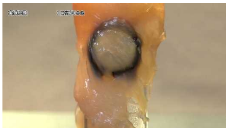
鶏肉を使用したコイン形リチウム電池の誤飲の再現実験
