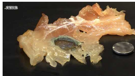
鶏肉を使用したコイン形リチウム電池の誤飲の再現実験
