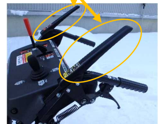
デッドマンクラッチ機構
