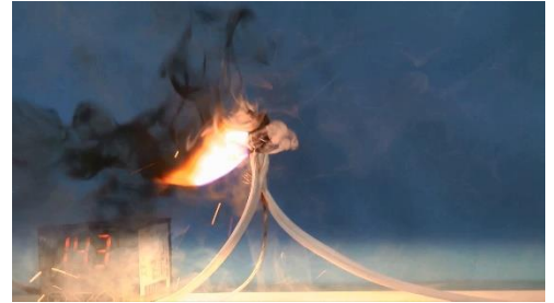
電源コードのねじり接続部から発火する実験映像
